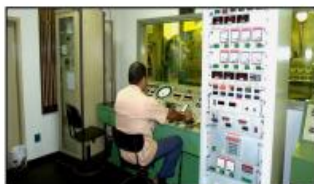
Bancada de Testes de Motores
